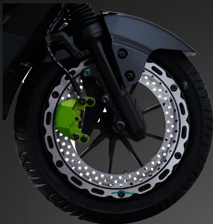
Verificar periódicamente el líquido de freno. Si la potencia de frenado disminuye, se debe revisar que no exista ninguna fuga de líquido en la manguera.
