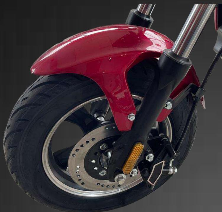
Verificar periódicamente el líquido de freno. Si la potencia de frenado disminuye, se debe revisar que no exista ninguna fuga de líquido en la manguera.
