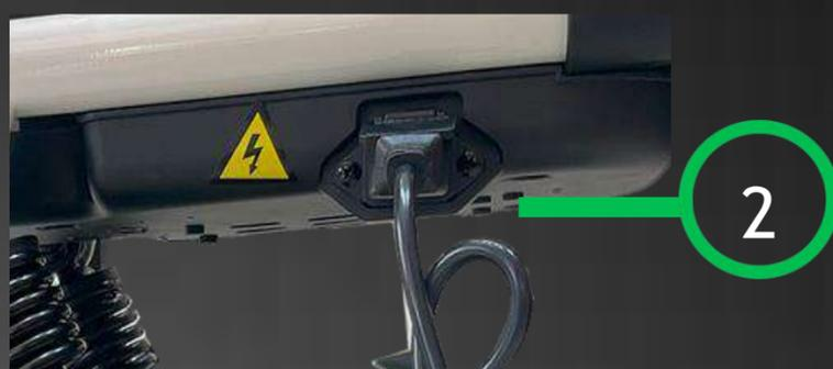
PASO 2: Conectar el cargador a la toma de carga la batería (2). Luego conectar el enchufe del cargador a la toma corriente de 220v (3). Mostrara un indicador (4) color rojo (batería cargando).
