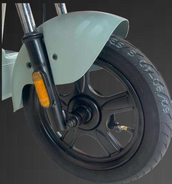
Ambos frenos: Girar en sentido horario la tuerca para ajustar el freno, (si siente que el freno tarda en detener el vehículo).
