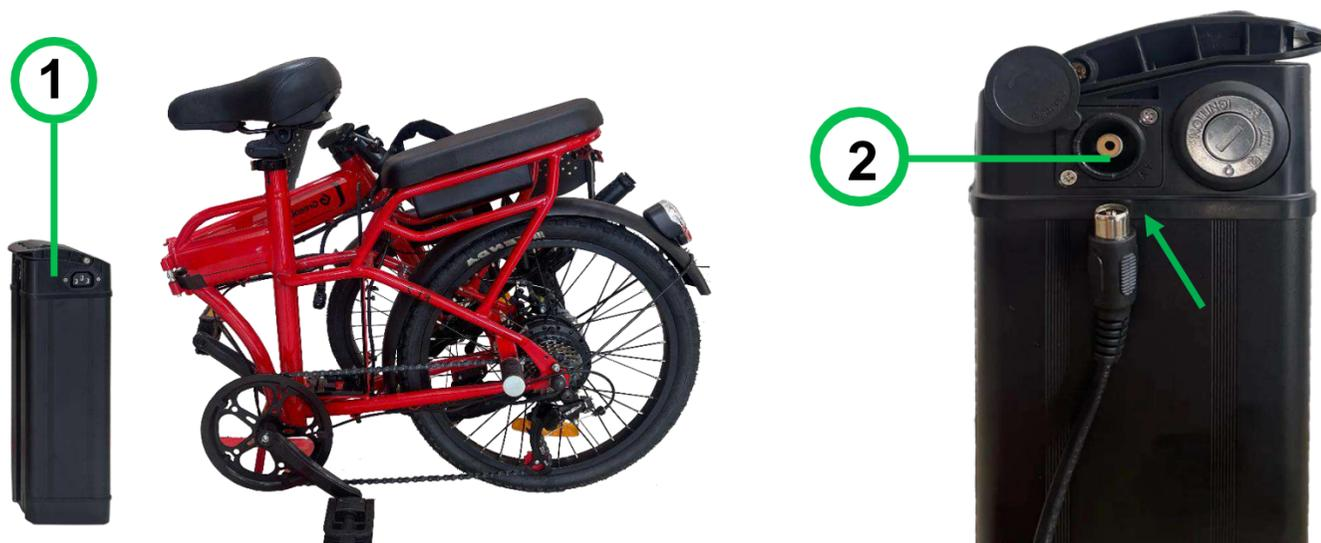
PASO 2: Conectar el cargador a la toma de carga la batería (2). Luego conectar el enchufe del cargador a la toma corriente de 220v (3) . Mostrara un indicador (4) color rojo (batería cargando).
