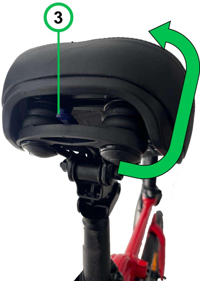
3. Presionar la palanca debajo del asiento y levantar
