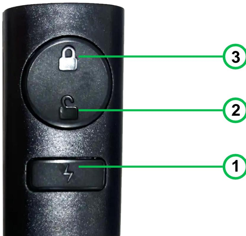
1. Encendido inalámbrico: Presionar dos veces el botón ⚡ para el encendido del vehículo. Se podrá visualizar la activación del tablero digital.
