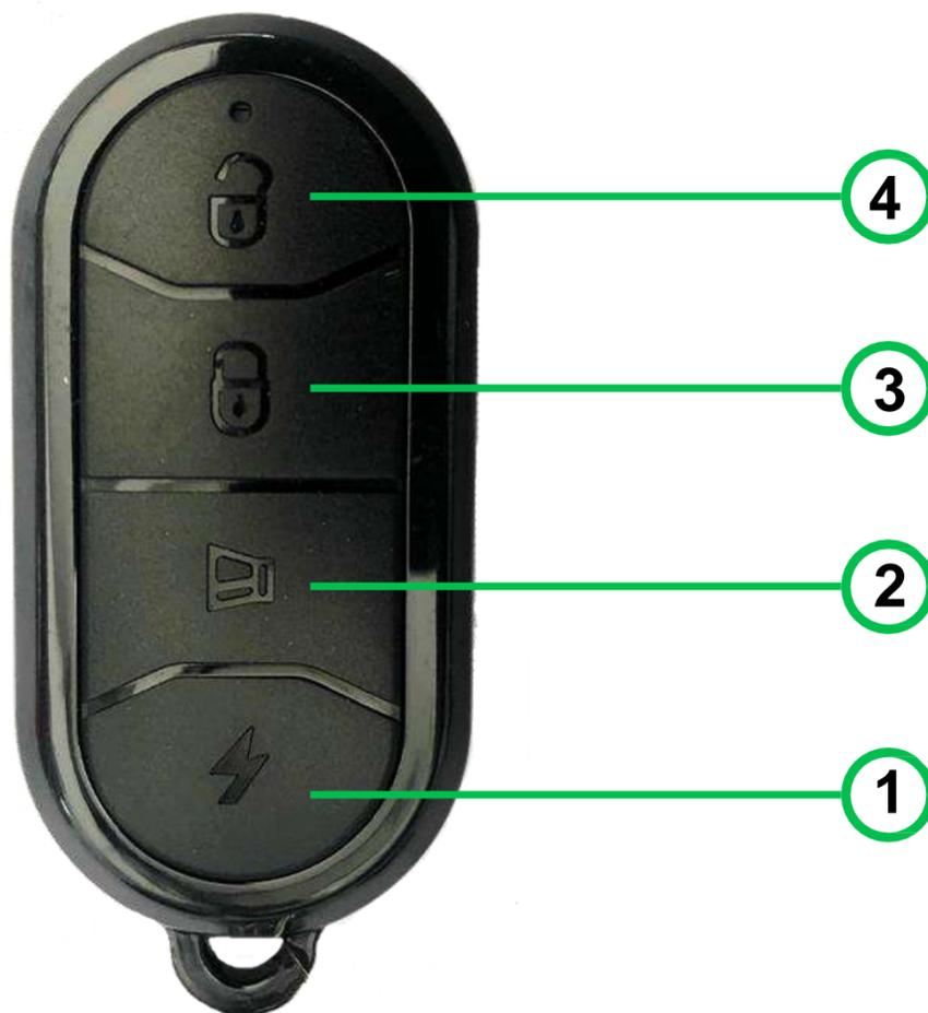
1. Encendido inalámbrico: Presionar dos veces el botón ⚡ para el encendido del vehículo. Se podrá visualizar la activación del tablero digital.
