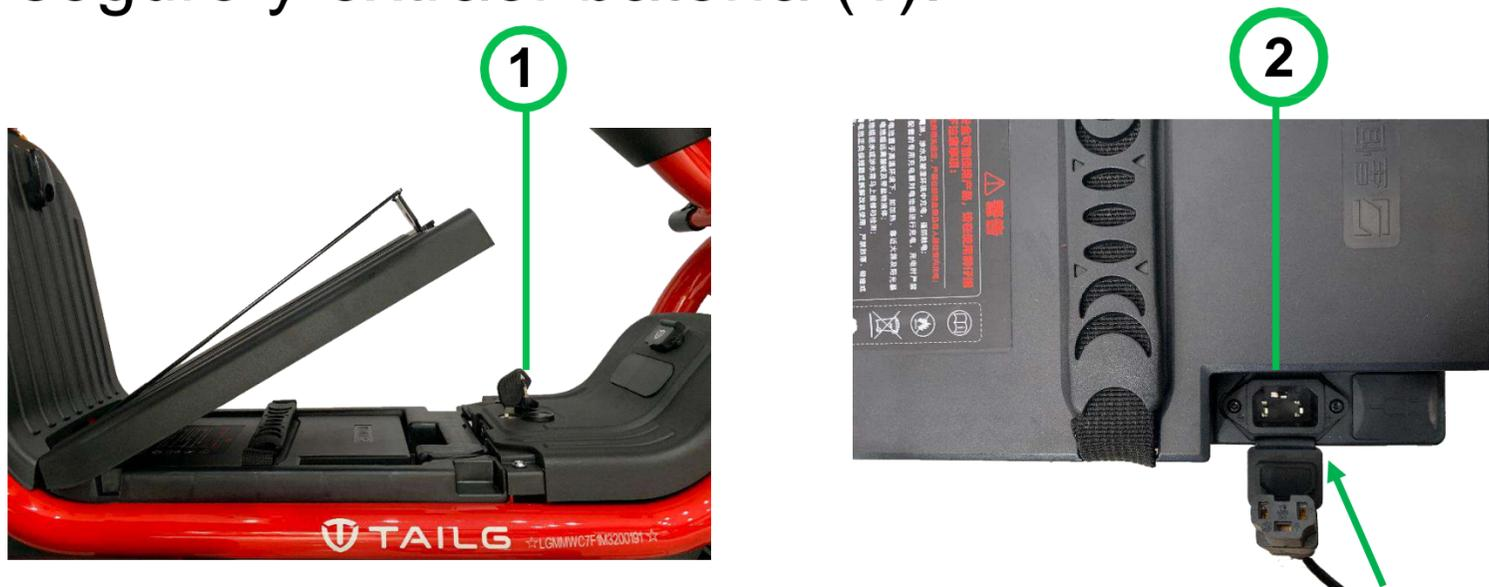
PASO 2: Conectar el cargador a la toma de carga la batería (2). Luego conectar el enchufe del cargador a la toma corriente de 220v (3) . Mostrara un indicador (4) color rojo (batería cargando).
